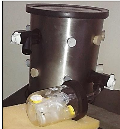
Figura 10- Liofilizador de modelo Lyph Lock 4.5 Labconco. Neste tipo de equipamento as amostras são colocadas na mesma câmara de liofilização.
