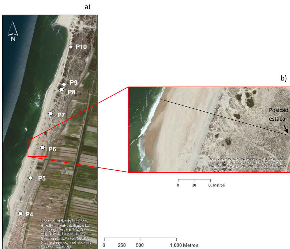
Figura 4. 8 - Localização dos perfis no trecho em estudo a); exemplo do percurso percorrido na obtenção dos dados de levantamento b).
