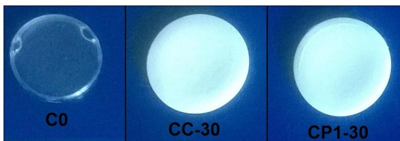
Figura 39 - Fotografia dos vários tipos de compósitos preparados ao longo deste projeto com os pós de óxido de zinco precipitados (CP1-30) e com os pós de óxido de zinco adquiridos comercialmente (CC-30), e o filme de poliuretano puro (C0).
