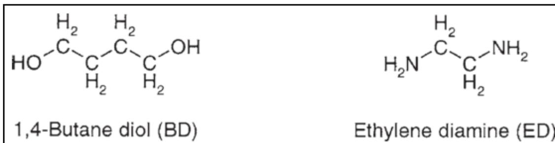
Figura 7 - Extensores de cadeia frequentemente usados na síntese de poliuretanos.
