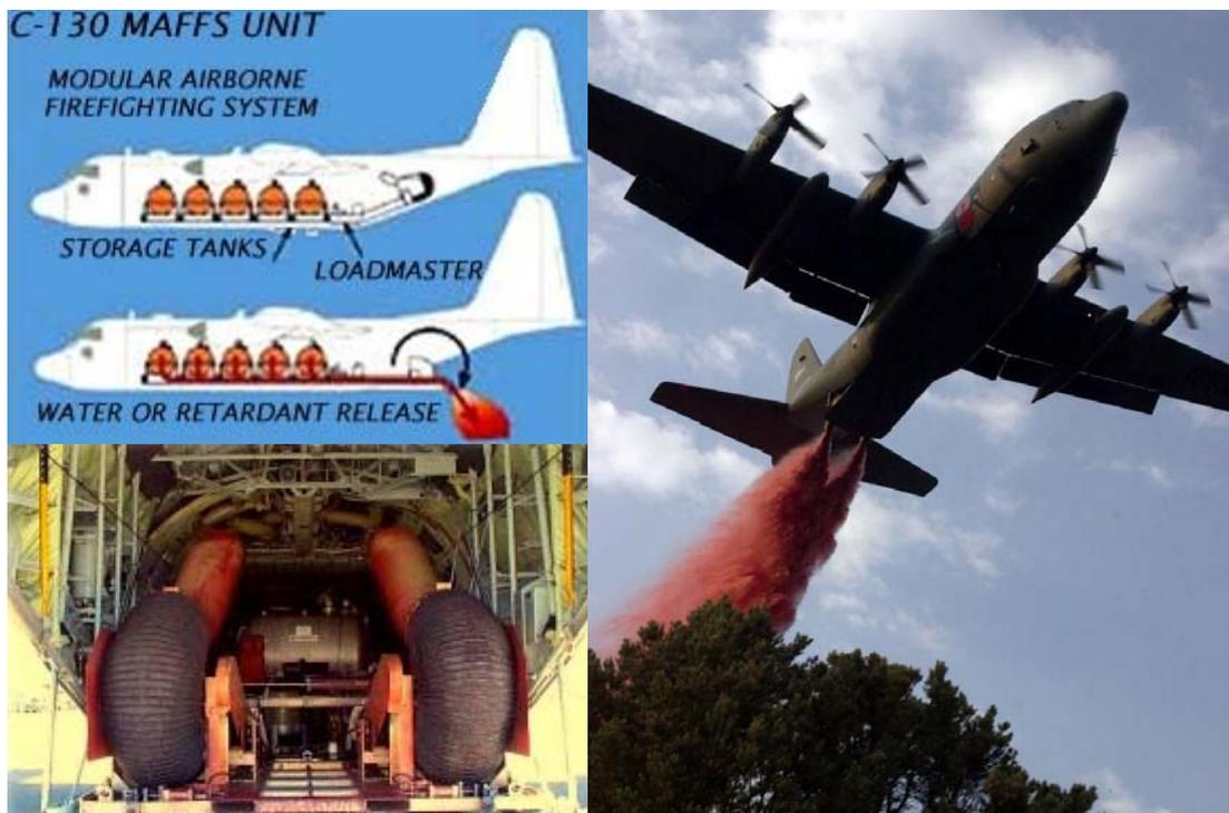
Figura 2.2 – Sistema MAFFS para acoplamento em aviões Hércules C-130.
