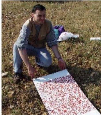
Figura 3.7 – Sistema simples para amostragem de gotas de retardante.
