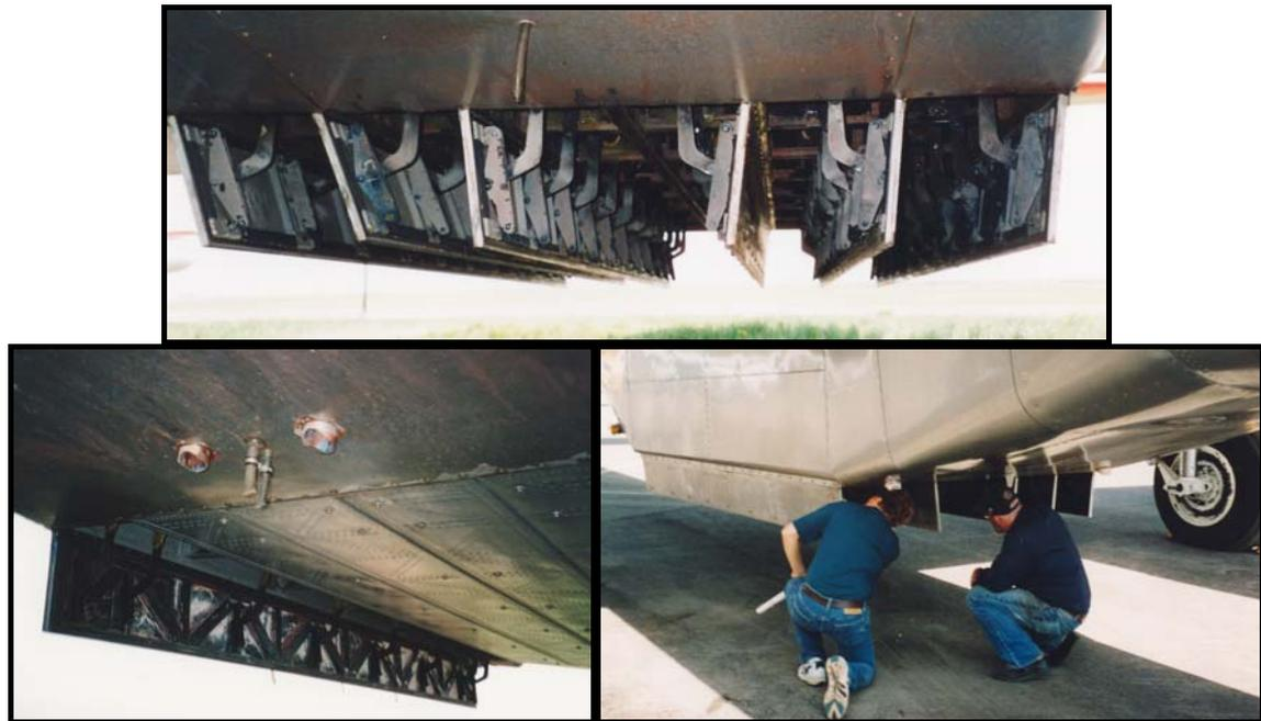
Figura 2.1 – Tanque aéreo e respectivo sistema de abertura das 6 portas independentes.
