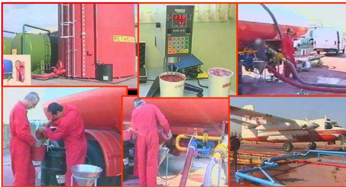
Figura 3.1 – Imagens relativas às acções no aeroporto de Marignane durante a preparação do retardante e enchimento do aerotanque.
