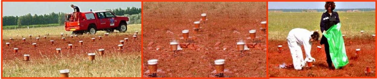
Figura 3.3 – Imagens relativas ao procedimento da medição da precipitação de retardante através da grelha de recipientes.
