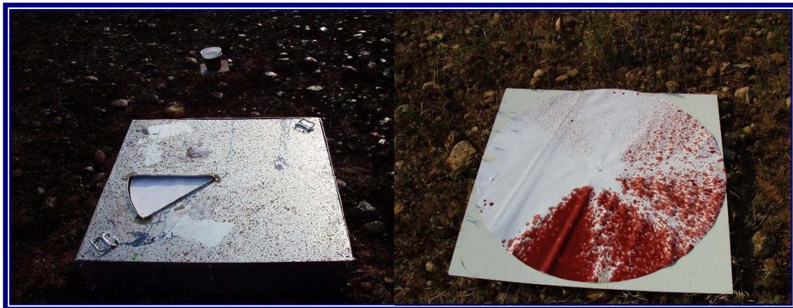
Figura 3.8 – Sistema rotativo para medição do tamanho das gotas de retardante
