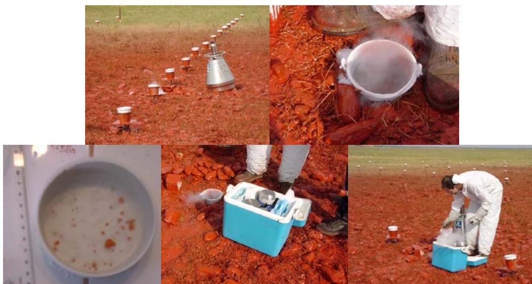
Figura 3.9 – Utilização de azoto líquido para amostrar gotas de retardante.
