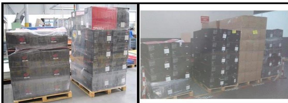
**Figura 16** – Aplicação do Seiri e Seiton: Produto não conforme (Esquerda: Produto não conforme no centro do setor; Direita: Produto não conforme no local definido e delimitado, distante do material conforme)
