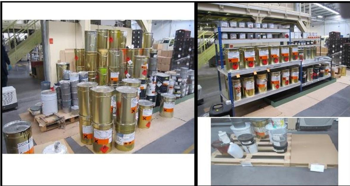
**Figura 21** – Aplicação do Seiri e Seiton: Tintas (Esquerda: Latas de tinta no chão, empilhadas, misturadas e sem identificação; Direita: Latas de tinta dispostas em estantes, de fácil manuseamento, identificadas e com a separação da sucata e das latas de tinta não conforme)
