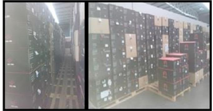
**Figura 17** – Aplicação do Seiri e Seiton: Excesso de produção (*Esquerda*: Excesso de produção empilhado desordenadamente e sem identificação da encomenda e artigo em cada caixa; *Direita*: Excesso de produção empilhado em 2 filas, viradas para o observador, com local predefinido e caixas com mesmo artigo próximas, com a identificação da encomenda e artigo através de um papel em cada caixa)
