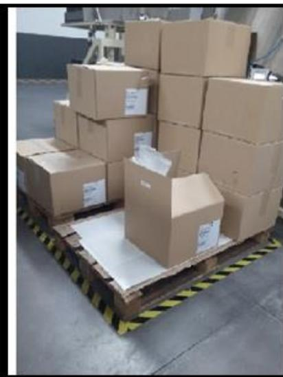
**Figura 19** – Aplicação do Seiri e Seiton: Discos Saranex / Tin Saran (*Esquerda*: Paletes dos discos distantes da máquina e sem local delineado; *Direita*: Paletes dos discos próximos da máquina, no local delineado)
