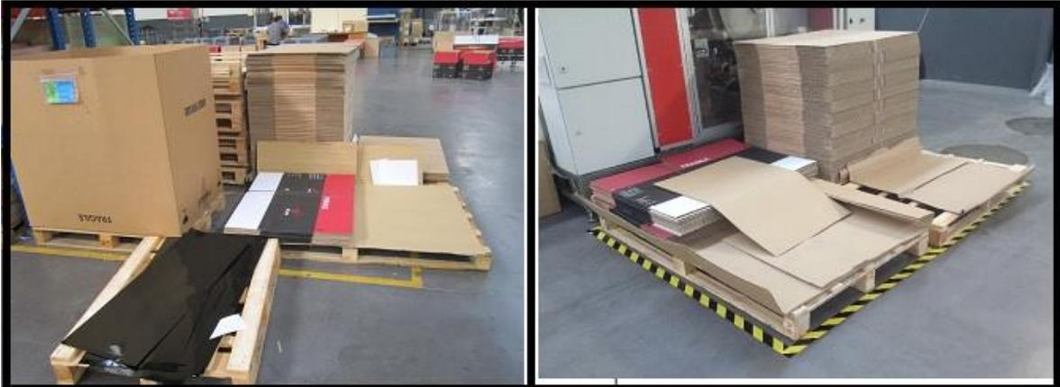
**Figura 20** – Aplicação do Seiri e Seiton: Caixas anónimas / Relvin (Esquerda: Paletes das caixas de cartão distantes da máquina e no centro do setor para ambas as linhas de produção; Direita: Paletes das caixas de cartão próximas da máquina de cada linha de produção, no local delineado)
