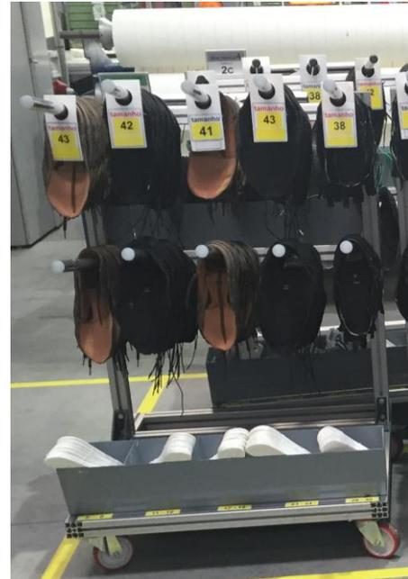
Figura 12. Carro tubular com gáspeas e palmilhas de strobel.
