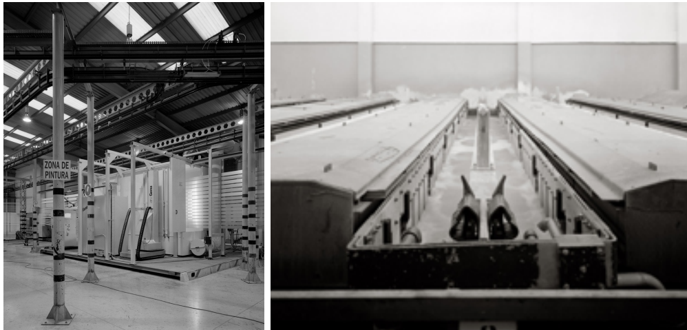
Figura 2.6: Tratamento de superfície: lacagem (à esquerda) e anodização (à direita).
