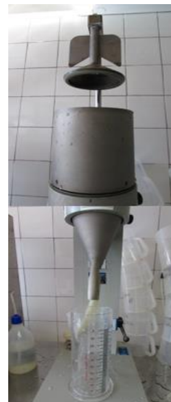
Figura 2. 5 – Equipamento de medição do grau Schopper - Riegler
