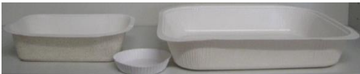
Figura 1. 11 – Recipientes obtidos pela utilização de um processo de estampagem. [37]
