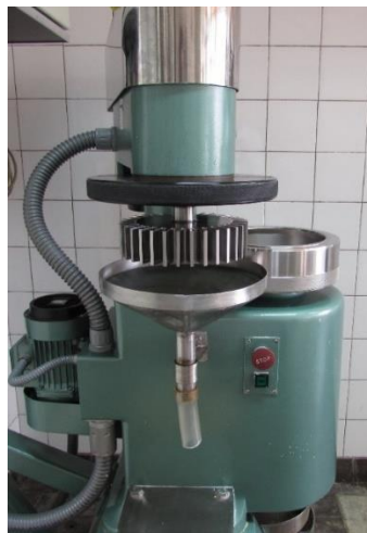
Figura 2. 4 – Refinador laboratorial do tipo Moinho PFI, presente nos laboratórios da empresa.
