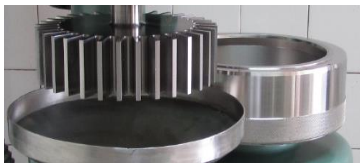
Figura 1. 8 - Estrutura de um rotor de um moinho PFI
