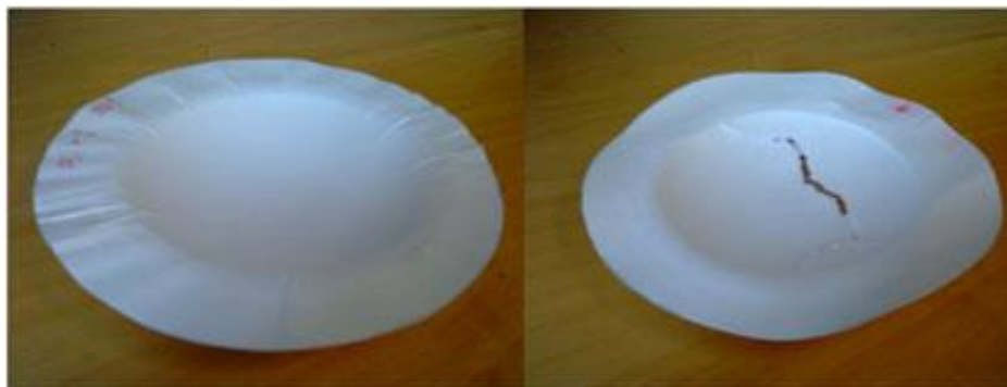
Figura 1. 12 – Exemplo de uma estampagem sem ocorrência de defeitos e com ocorrência de defeitos [38]
