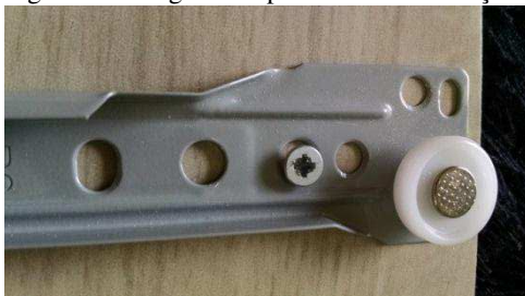
Figura 31: Desgaste do parafuso da corredeira
