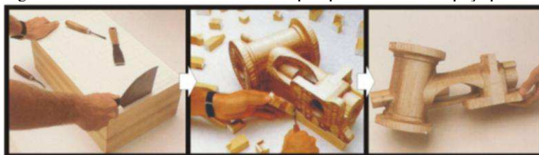
Figura 11: Processo baseado em lâmina: pós-processamento e peça pronta
