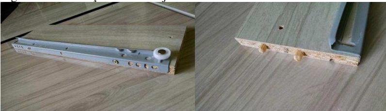
Figura 30: Corredeiras e cavilhas já montadas
