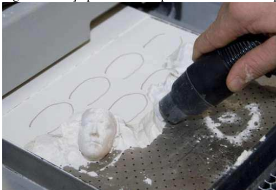
Figura 10: Peça produzida em processo baseado em pó.
