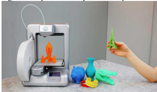
Figura 8: Impressora 3D que utiliza o processo FDM.
