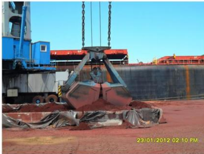
Figura 23: Auxílio do Grab para o carregamento
