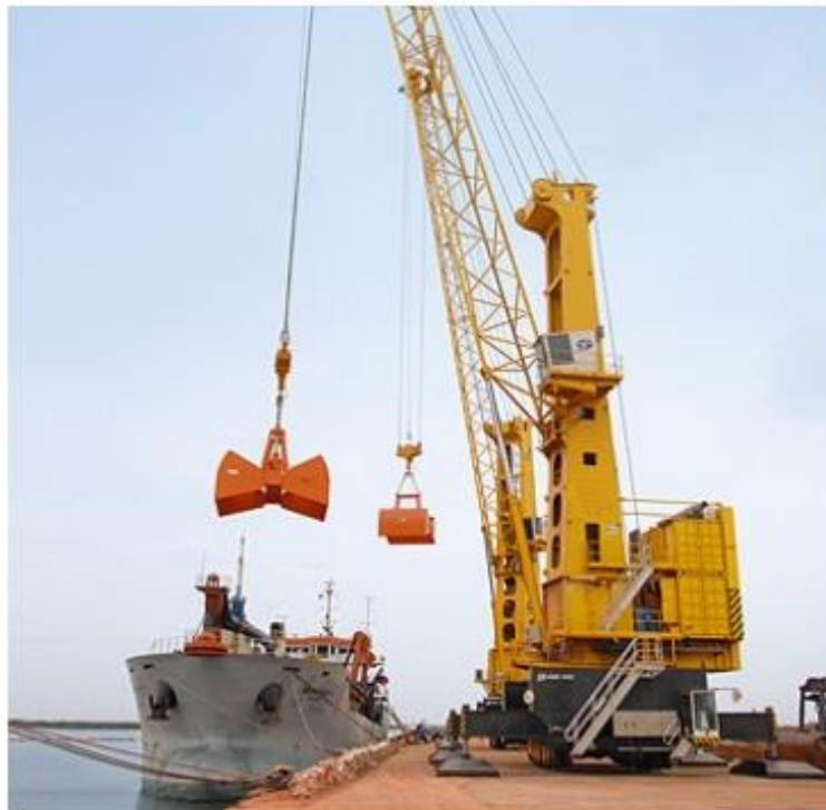
Figura 8: Grab acoplado em um guindaste MHC
