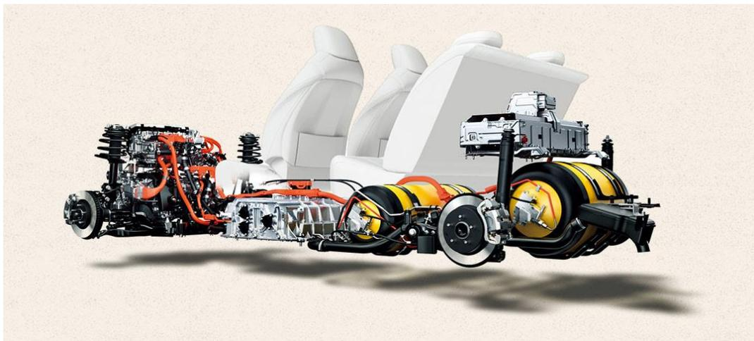
Figura 8 – Esquema dos tanques de hidrogênio no Toyota Mirai (Fonte: TOYOTA, 2016).
