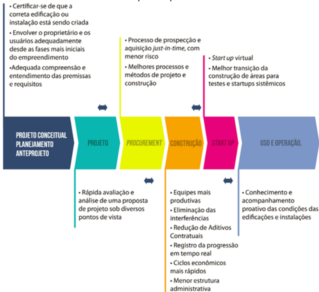
Figura 5: Principais benefícios da adoção do BIM nas macrofases do ciclo de vida de um típico empreendimento.
