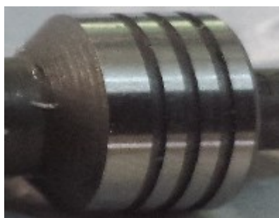
Figura 4.9 – Detalhe dos entalhes em um ressalto do carretel.
