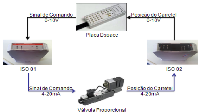
Figura 6.2 – Condicionamento de sinais Válvula/Placa através dos ISOs.
