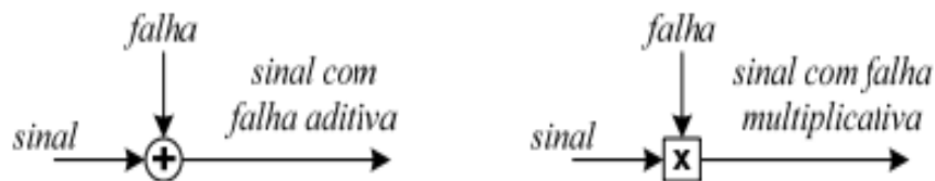
Figura 3.2 – Tipo de sinal de falha: aditiva e multiplicativa [5].
