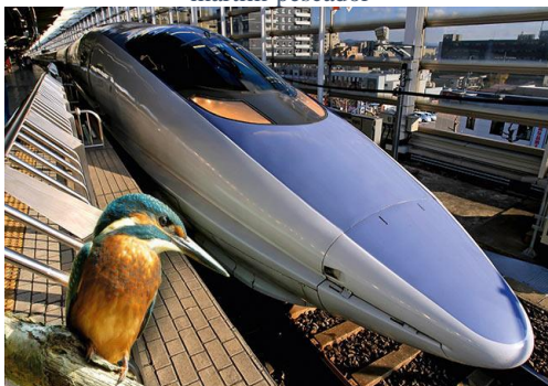
Figura C.4 - Frente do trem-bala desenvolvido a partir da analogia com a bico no martim-pescador
