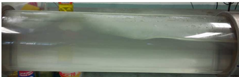
Figura 97 – Padrão de escoamento estratificado intermitente com a presença da bolha.
