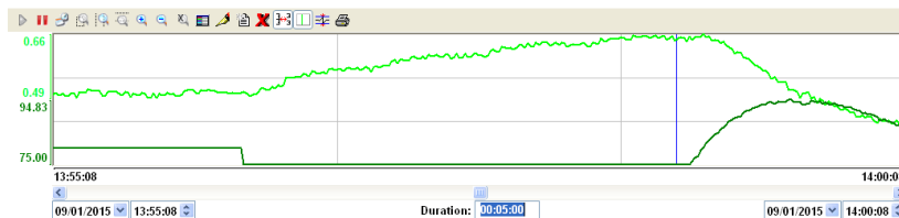
Figura 28 – Resposta ao degrau em malha aberta do controle de pressão PCV-1 (obtido do software Indusoft Web Studio).
