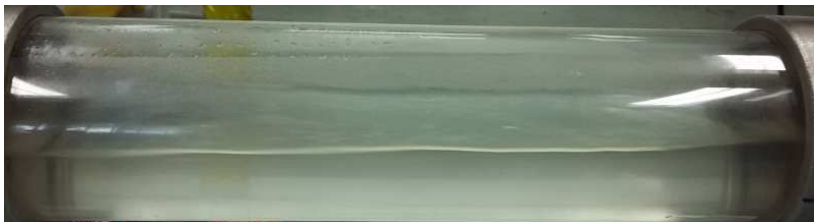
Figura 94 – Padrão de escoamento estratificado.
