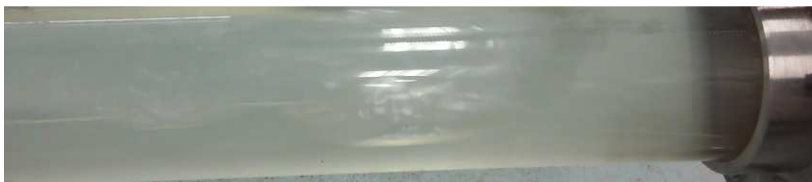
Figura 98 – Padrão de escoamento tipo golfada.
