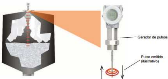
Figura 105 – Pulsos gerados por emissor de radiofrequência (extraído de [44]).
