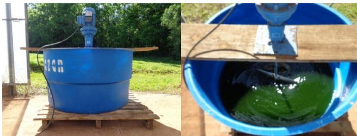
**Figura 4** - Reator utilizado para cultivo de microalgas sob condições naturais.
