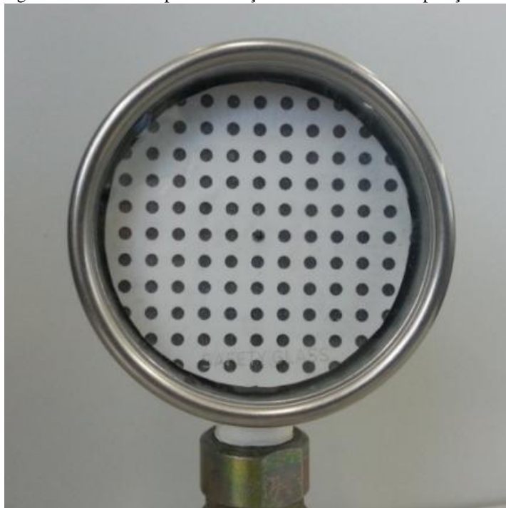
Figura 20 – Gabaritos para calibração da câmera com composição de lentes
