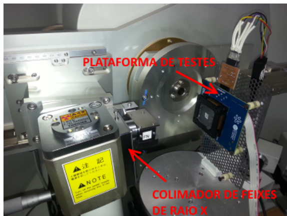
Figura 72 – Detalhe da plataforma de testes sob o feixe de raios X.
