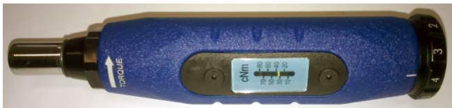
Figura 35 – Micro torquímetro utilizado para apertar os soquetes da IronWood.
