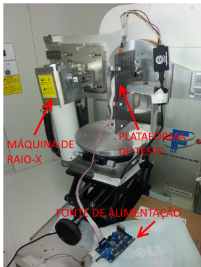
Figura 71 – Difratômetro de raio X Shimadzu XRD-7000 utilizado nos testes.
