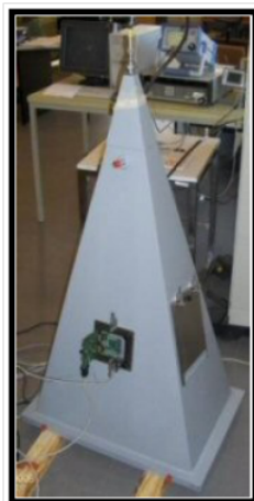
Figura 18 – TEM Cell utilizada para teste de PCBs com 10x10cm.
