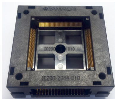
Figura 36 – Detalhe do soquete Yamaichi utilizado na Spartan 3E.
