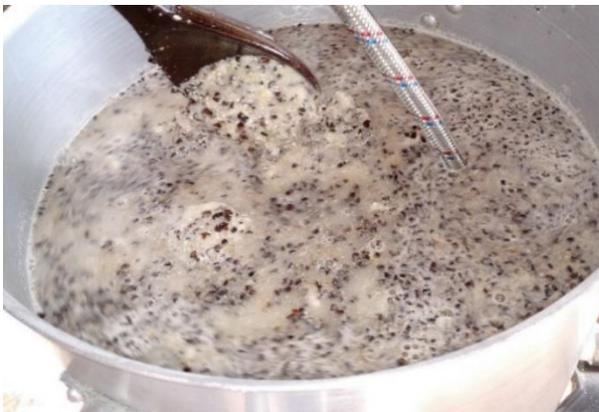
Após o descanso proteico a 45 °C, a temperatura foi aumentada até 80 °C, sendo que antes de chegar à temperatura de gelatinização do amido das matérias-primas (50 °C), foram adicionados 10 mL de enzima Termamyl SC DS®. A temperatura foi mantida a 80 °C por 50 minutos, reduzida para 65 °C e então foram adicionados 10 mL de enzima Saczyme®.
