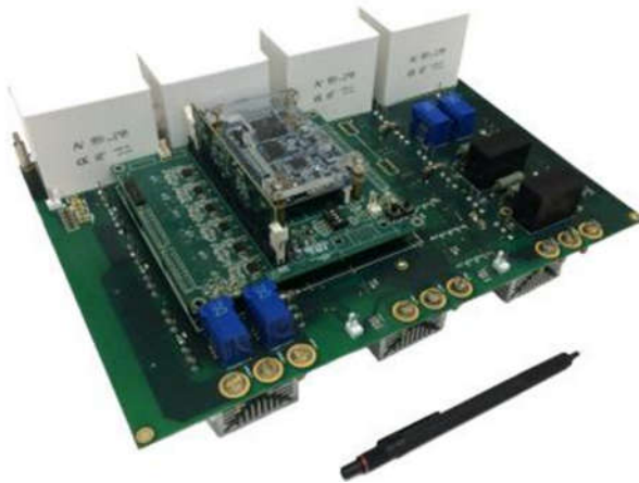
Figura 119 – Fotografia do protótipo implementado em laboratório para obtenção dos resultados experimentais da modulação proposta para o sistema back-to-back baseado no conversor NPC três níveis.
