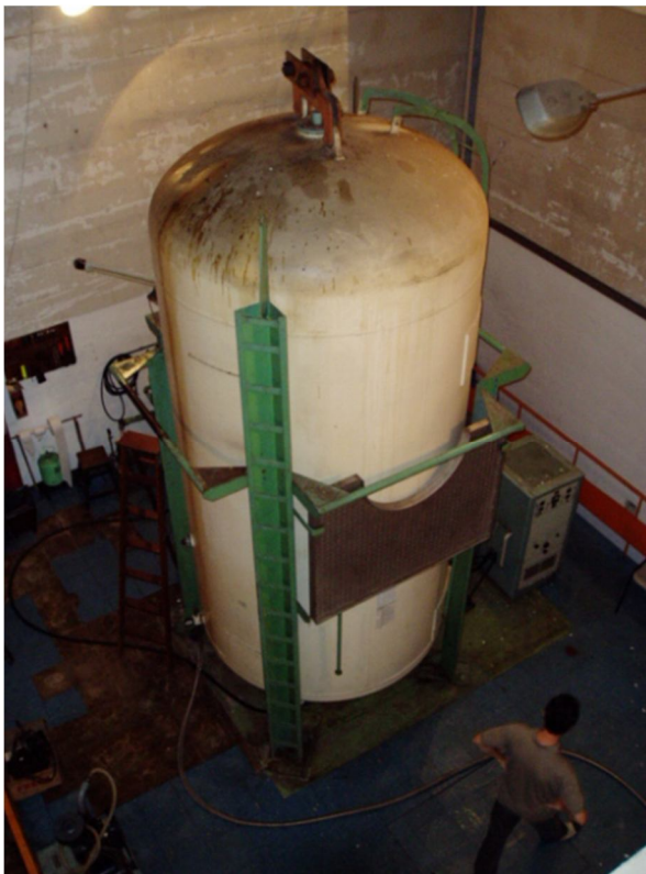
Figura C.2 – Tanque externo do acelerador Van de Graaff da PUC-Rio.
