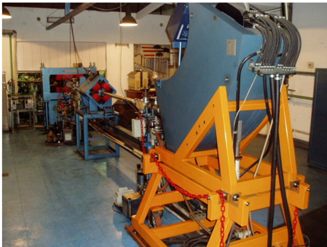
Figura C.3 – Eletroímãs na linha do feixe de íons do acelerador Van de Graaff.
