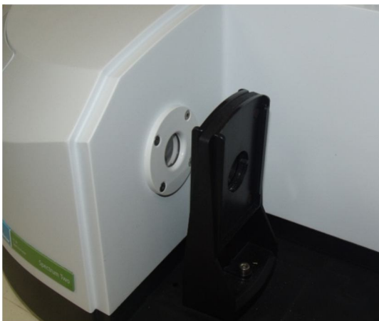
Figura C.8 – Detalhe interno do aparelho FTIR onde se encaixa o porta-amostras.
