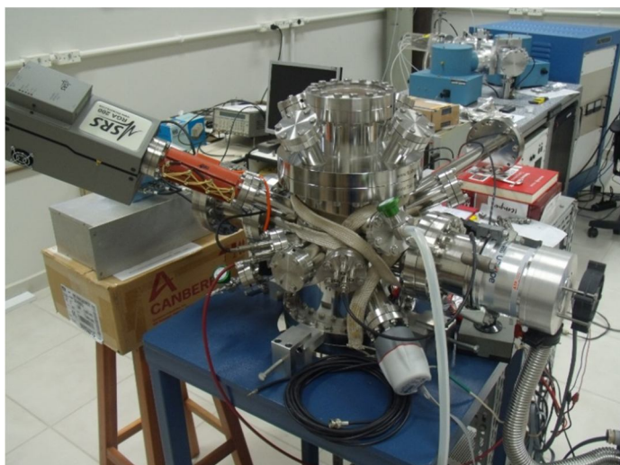
Figura C.12 – RGA 200 instalado na câmara de irradiação com elétrons na UFSC.
