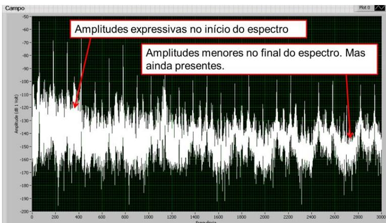
Para a unidade de monitoramento instalada do lado externo ao *housing* do gerador, a FFT do sinal de campo magnético (Figura 63) mostra um espectro menos rico de informações se comparado ao lado interno do *housing* apresentadas na Figura 61 e Figura 62. Acima dos 420 Hz praticamente todas as harmônicas da fundamental mecânica com exceção das harmônicas elétricas ficam abaixo dos -130 dB V.
