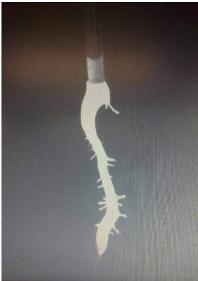
**Figura 10: Filme de CA formado na ponta do injetor (Fonte: Próprio autor).**
