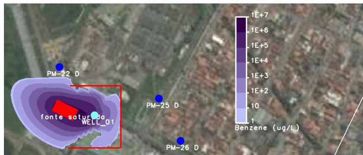
Figura 13 - Pluma de simulação de benzeno (gasolina pura) contida pela barreira física e bombeamento após 15 anos – SCBR.
