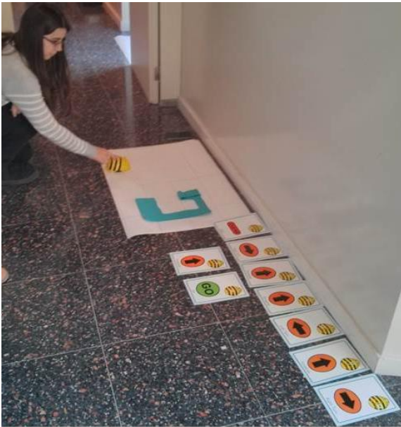
Figura 2. Seqüència d'instruccions per definir el moviment del robot. El kit de Bee-Bot porta fitxes de cartró per representar cadascuna de les instruccions, però també es poden crear a classe o escriure les instruccions amb llapis i paper.
