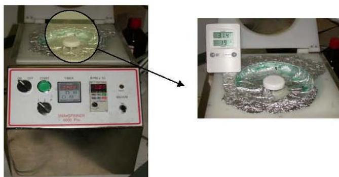
**Figura 2-8** Imagen del dispositivo usado en el laboratorio para la realización del recubrimiento por plato rotatorio
