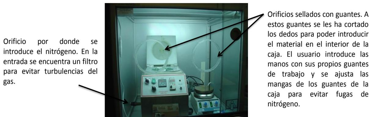
**Figura 2-9** Fotografía de la caja de humedad controlada en la que encontramos la placa calefactora y el dispositivo de recubrimiento por plato rotatorio.
