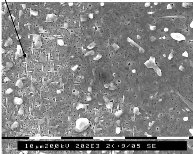
**Figura 3-18** Imagen de SEM correspondientes a una capa de YBCO crecida sobre LAO a  $795^\circ\text{C}$
