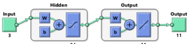
Fig. 5. Imagen de la arquitectura de red neuronal utilizada para resolver el problema. Imagen generada por Matlab.
