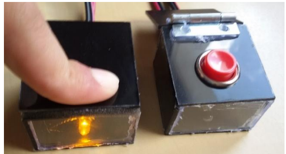
Figura 12: Comparación de un pulsador encendido y con superficie adaptada y uno sin esa superficie donde se ve la bisagra guía.
