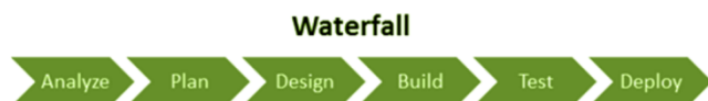
Fig. 7. Descripció gràfica de la metodologia Waterfall en la que per passar de fase a fase, les necessitats de l'anterior han d'haver estat satisfetes completament.
