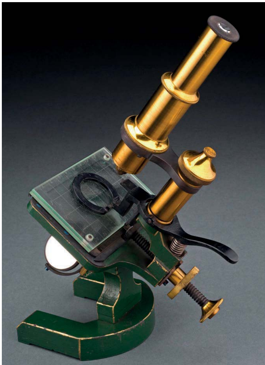
Fig. 4: Microscopio del siglo XIX usado para la inspección de carnes. Wellcome Library. L0057251 Compound microscope used to examine meat, France, 1851-1900. [Citado 27 febrero 2016]. Disponible en: https://commons.wikimedia.org/wiki/File%3ACompound_microscope_used_to_examine_meat%2C_France%2C_1851-1900_Wellcome_L0057251.jpg
