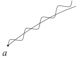
Figura 2.1: Ilustração esquemática das soluções do sistema original e do sistema promediado . A solução promediada de primeira ordem move-se lentamente ao longo de um arco suave, enquanto que a solução original sofre pequenas oscilações e afasta-se gradualmente.
