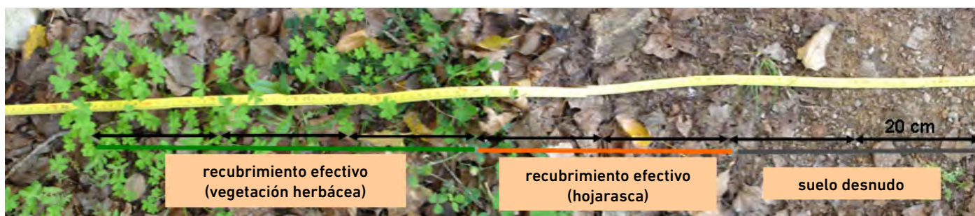
Figura 12. Fragmento de transecto para la medida del recubrimiento efectivo del suelo delimitado mediante una cinta métrica. Se observan tres secciones de 20 cm donde predomina el recubrimiento herbáceo, dos donde el recubrimiento se debe a la hojarasca y dos más donde no hay plantas ni restos vegetales en las que se observa el suelo desnudo (foto: V. Carabassa).
