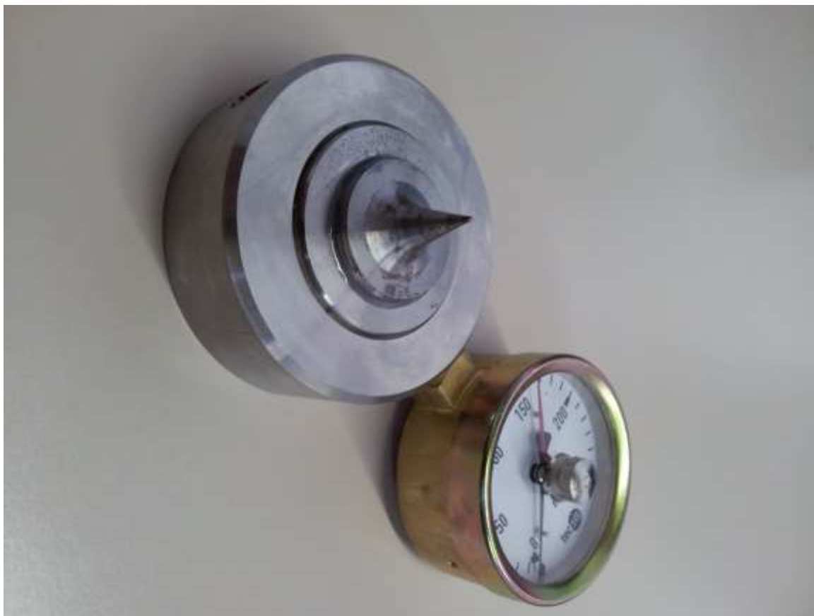
Figura 14. Dinamómetro F115 de Tecsis GmbH. El punzón central penetra en el canal femoral estabilizando la posición del mismo durante el ensayo.
