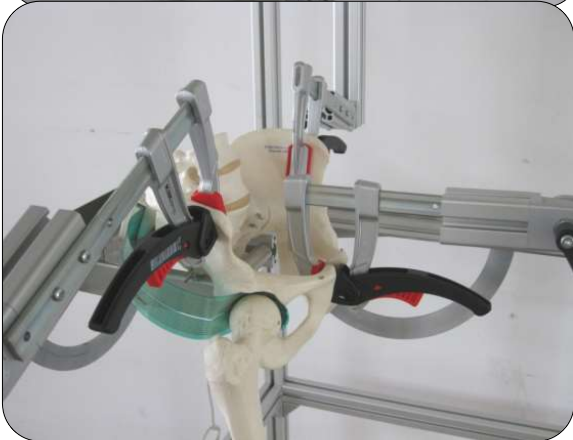
Figura 13. Detalle de la adaptación de un modelo de espécimen para valorar el control angular y la correcta adaptación del sensor de presión en la cavidad acetabular.
