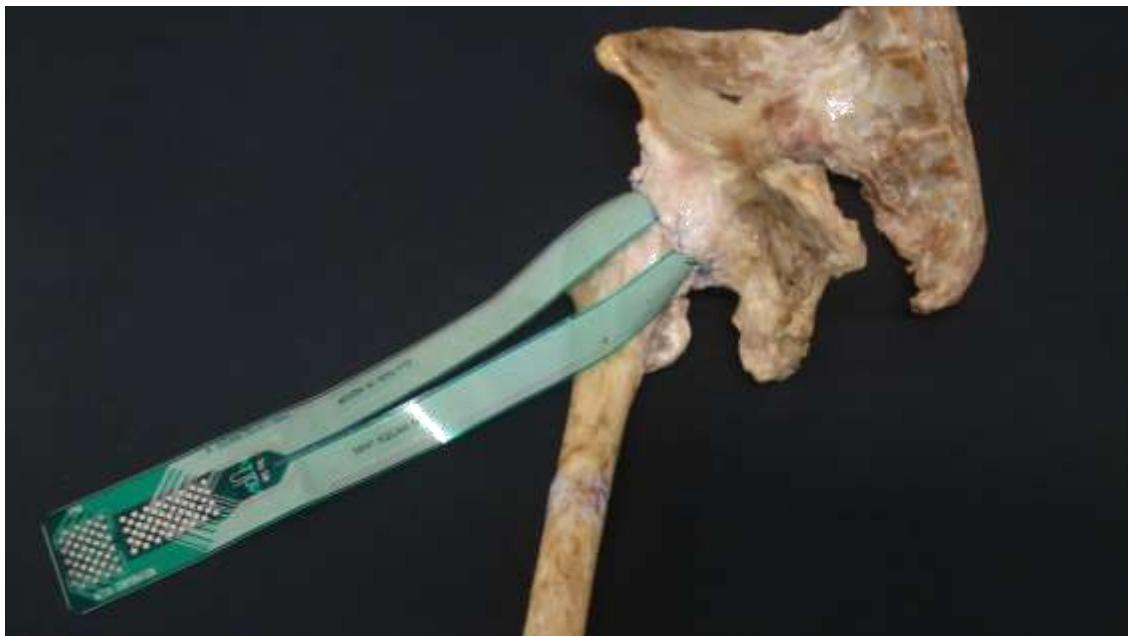
Figura15. Sensor de presión modelo 4010N colocado en su posición a través de la artrotomía anterior, que ya aparece suturada.
