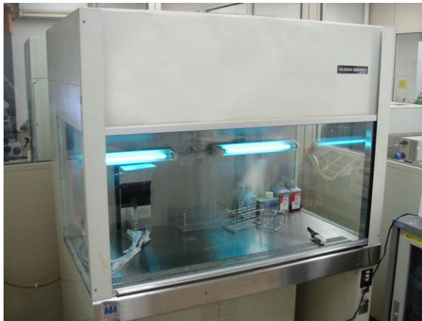
Fig.4C. Cleanbench . Font: http://www.osaka-med.ac.jp/deps/kik/4_cell.htm
