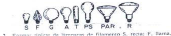
Figura 11.10.6.1.1. Tipus de làmpades incandescents amb la seva corresponent nomenclatura.
