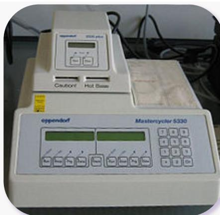
Imagen 44: Termociclador: aparato en el que se efectúa la PCR convencional.
