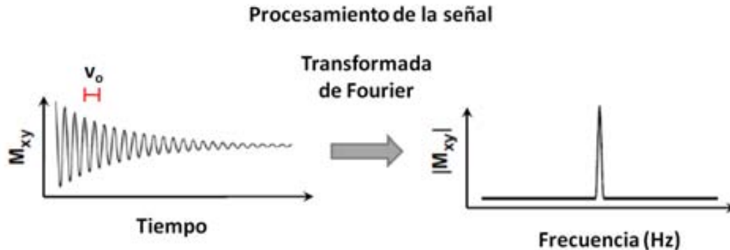
Figura 24: Esquema de la transformación de la FID (la magnetización transversal representada respecto al dominio del tiempo) registrada en un experimento de RMN, en un espectro (dominio de la frecuencia) tras la aplicación de la transformada de Fourier. Abreviaturas: M_{xy} = magnetización transversal, \nu_0 = frecuencia de precesión de Larmor.
