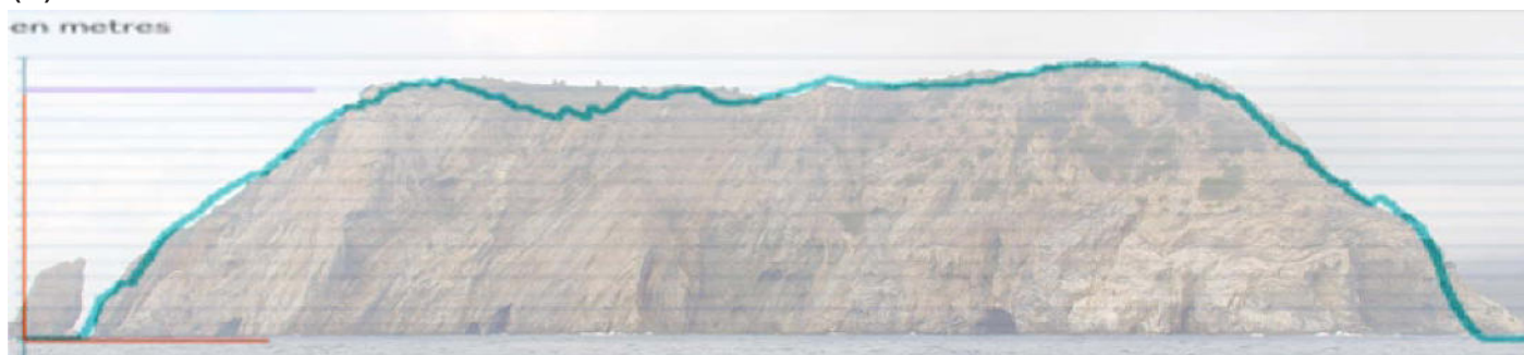
Fig.5. Obtenció del perfil base. (a): Fotografia realitzada a distància; (b): Perfils obtinguts mitjançant l'eina: ICC-Vissir: Editor/Dibuix de perfils. El blau correspon a la part més enlairada del penya-segat i el verd a un perfil paral·lel més proper al mar; (c): Encaix obtingut mitjançant lleugera deformació de l'imatge fotogràfica a fi d'encaixar-la en el perfil blau de "(b)".
