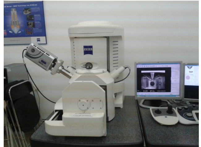
Figura 3. SEM-EDS Zeiss EVO MA 10.
