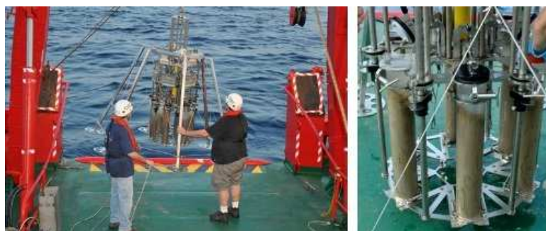
Imatge: Maniobra de recuperació del mostrejador de sediment utilitzat en l'estudi i detall dels tubs amb el sediment a dins. Autor: Jacobo Martín, ICM-CSIC.
