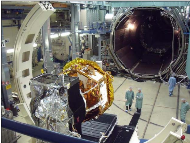
Figura 5: LISA Pathfinder en primer pla abans de ser introduït en un simulador d'espai (al fons) on el satèl·lit és sotmès a les mateixes condicions ambientals a les que farà front una vegada en òrbita. Crèdits: Astrium UK
