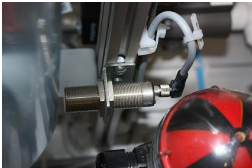
Figura 36. Fotografia detector de posició capacitiu. Font: Elaboració pròpia.
