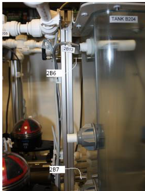
Figura 78. Fotografia localització dels detectors capacitius del dipòsit principal. Font: Elaboració pròpia.
