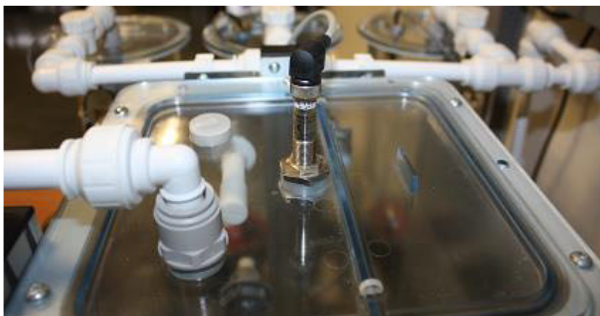
Figura 69. Fotografia del sensor de nivell Siemens. Font: Elaboració pròpia.
