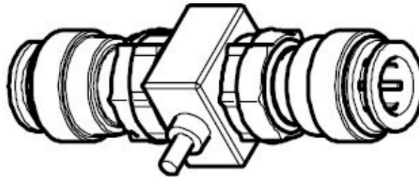
Figura 40. Disseny del detector de cabal d'aletes. Font: Datasheet del dispositiu.
