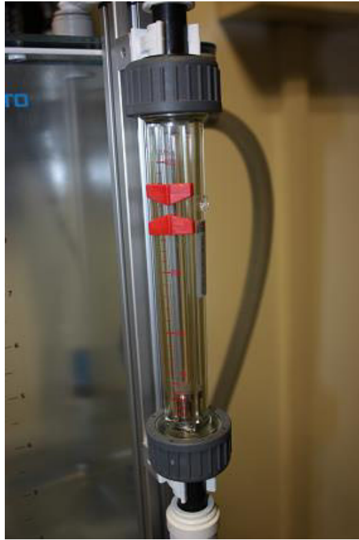
Figura 38. Fotografia del detector de cabal (mecànic). Font: Elaboració pròpia.
