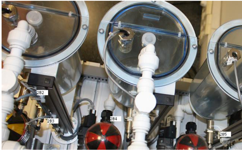
Figura 77. Fotografia localització dels detectors capacitius dels dipòsits dosificadors. Font: Elaboració pròpia.
