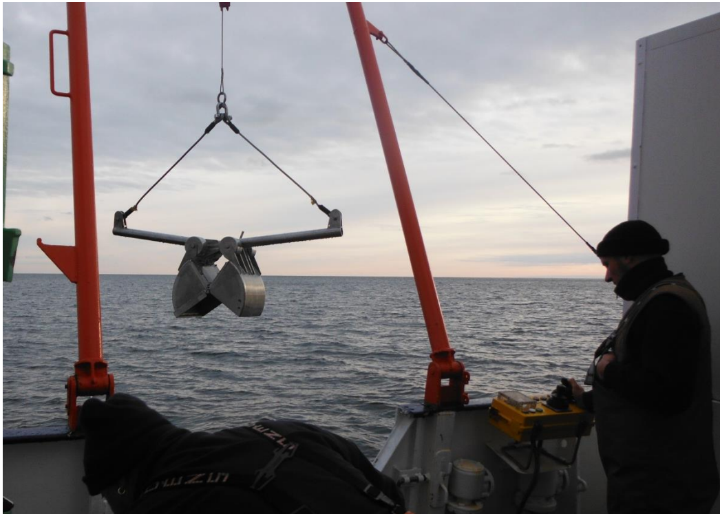
Abbildung 1: Backengreifer kurz vor der Probenentnahme
