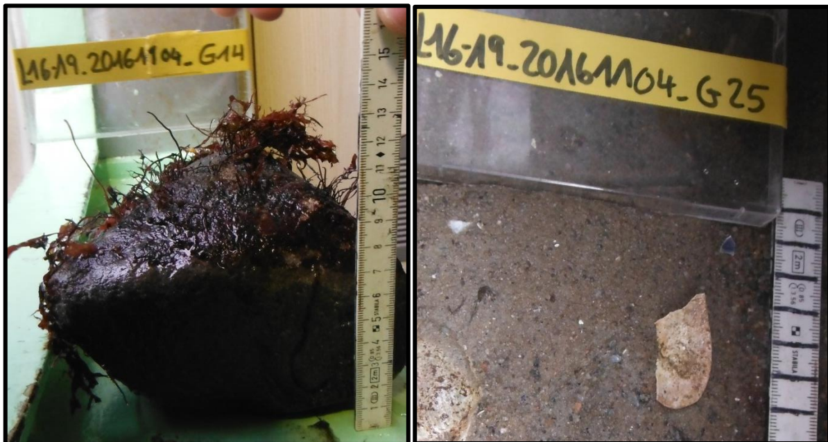
Abbildung 2: Fotos der Proben aus dem Backengreifer. (Links: Stein mit Bewuchs. Rechts: Mittelsand mit Grobsand und Schill)
