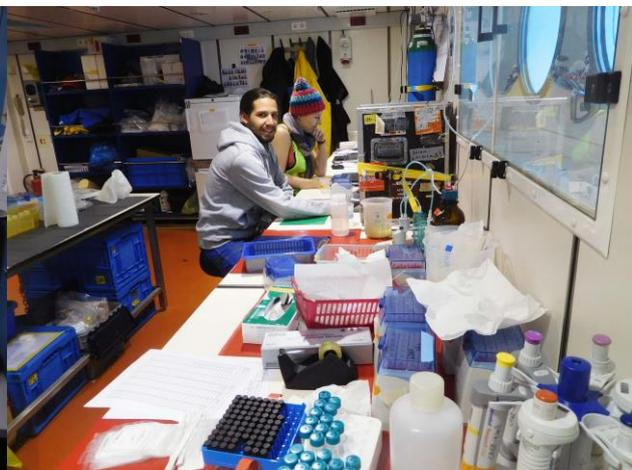
**Abbildung 4:** Blick ins Chemielabor, wo nach dem Auspressen der Sedimente das Porenwasser auf seine chemischen Bestandteile untersucht wird.
