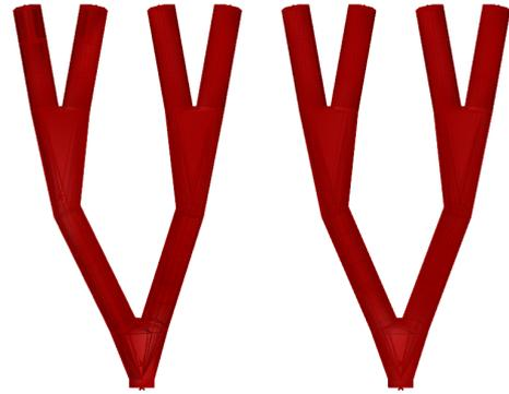
(b) In Twin6 verwendete Stützen;
