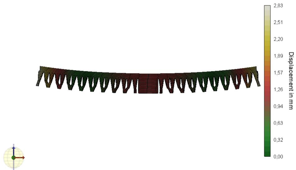
Abbildung 28: Simulation des Twin16 nach Ablösen von der Bauplattform
