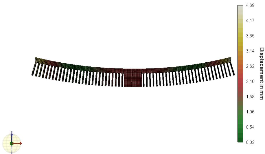
**Abbildung 21:** Bildliche Darstellung der Verschiebung (Displacement) des Twin8 nach Ablösen der Gesamten Struktur von der Bauplattform
