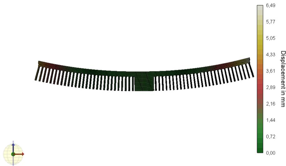
**Abbildung 20:** Bildliche Darstellung der Verschiebung (Displacement) des Twin8 nach Ablösen der Stützen von der Bauplattform
