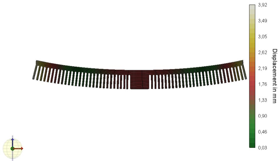
Abbildung 25: Simulation des Twin13 nach Ablösen von der Bauplattform
