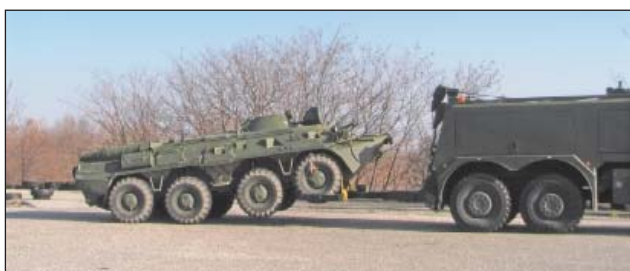
21. ábra. MAN HX-32 MVJ BTR-80-as harcjármű emelve vontatása közben a RÁBA Nyrt. écsi próbapályáján
