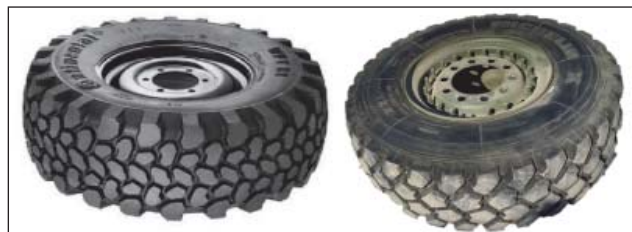
20. ábra Continental és Michelin gyártású 365/80 R 20 gumibroncsok
