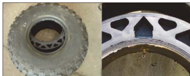
19. ábra. Run-Flat betét a DT-64 típusú ukrán gumibroncsához
