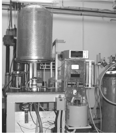
1. ábra. A saját építésű plazmanitridáló berendezés
