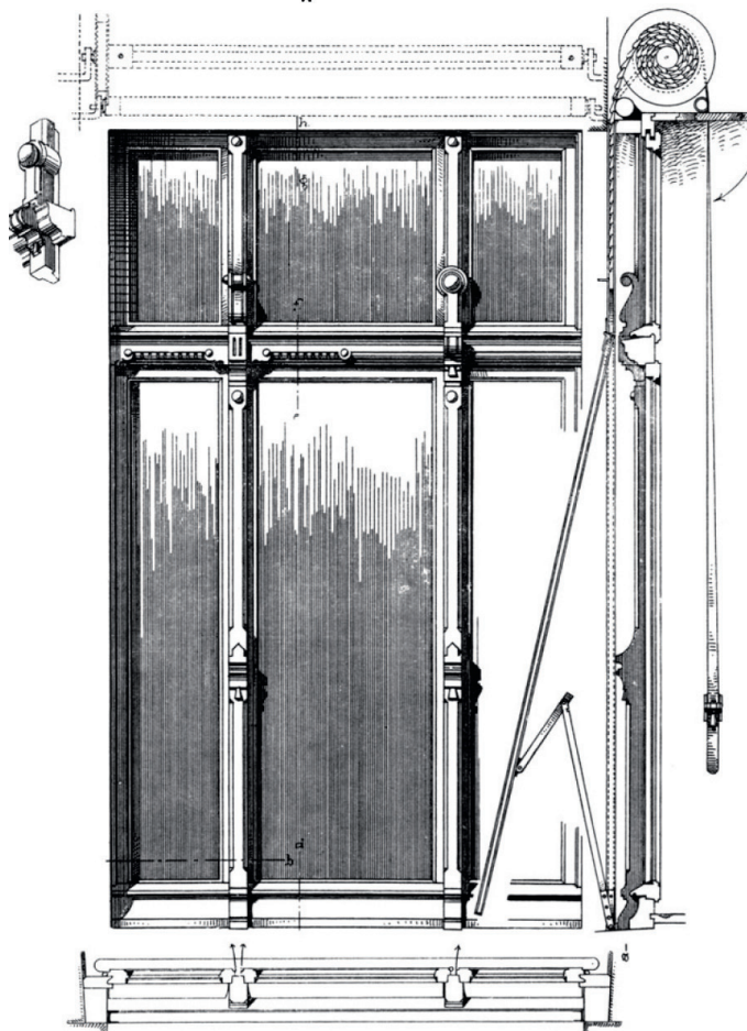
7. ábra: Kitémasztható karú esslingeni redőnyös ablak metszete és nézete [8]
