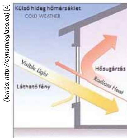
2. ábra: A low-E üveg működése
