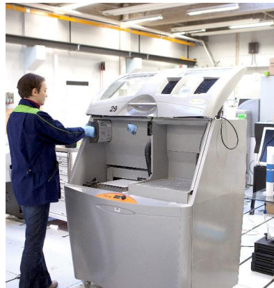
Kuva 7. Sideaineen suihkutukseen perustuva teollinen 3D-tulostin.
